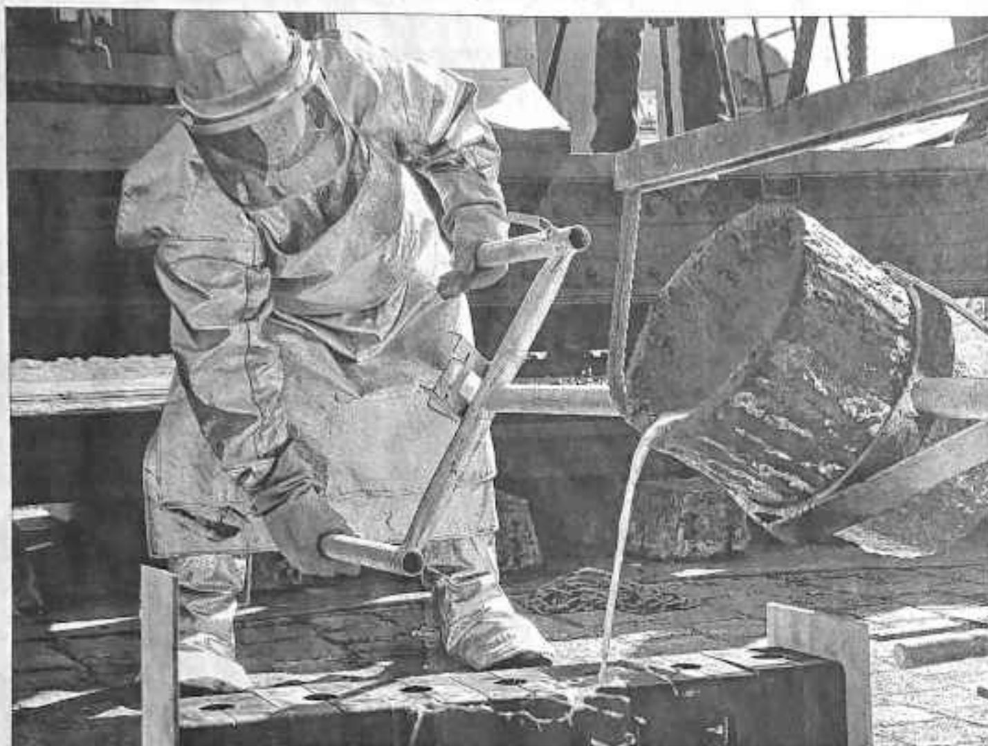
Bronzegießer Klaus Cenker bei seiner Arbeit: Die Schmelze ist in einem von ihm entworfenen Ofen auf über 1000 Grad Celsius erhitzt worden, ehe sie gegossen werden kann.
